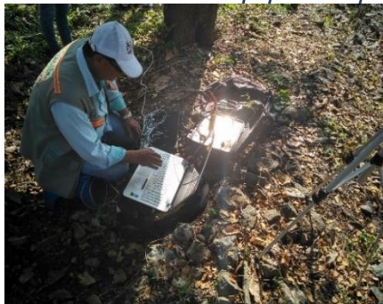
Equipo de medición de las Líneas de refracción sísmica
