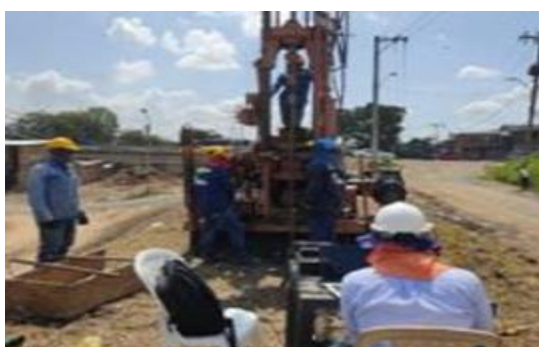
Foto 216. A la izquierda, última prueba SCPT en Puerto Nuevo; a la derecha tramo reforzado y empedrado de Puerto Nuevo.
