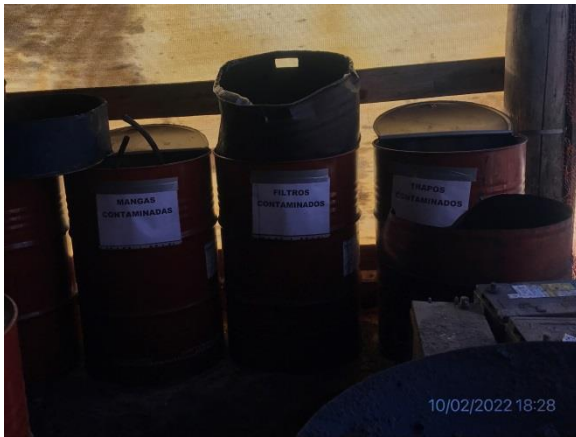
Ilustración 18 – P04, Obrador. Acopio de residuos contaminados con hidrocarburos en local techado, envallado y con pavimento impermeable.
