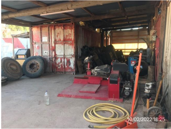
Ilustración 16 – P04, Obrador. Taller mecánico y acopio de cubiertas en local techado, envallado y con pavimento impermeable.
