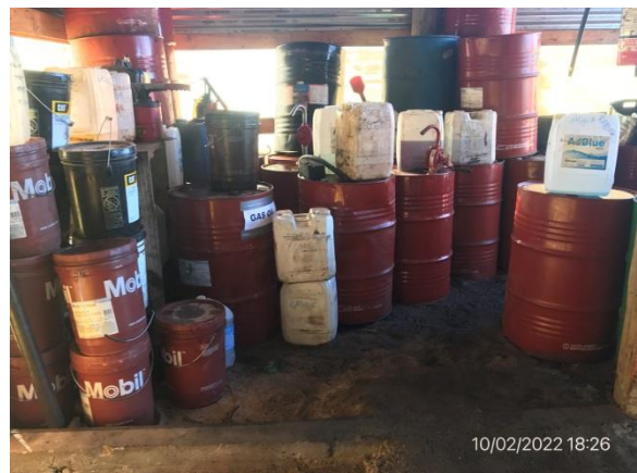
Ilustración 15 – P04, Obrador. Acopio de lubricantes en local techado, envallado y con pavimento impermeable.
