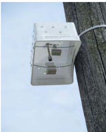
Figure 12 : Adsorbants des composés gazeux installés par le Certech.
