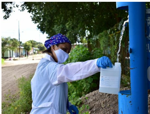
Toma de muestras de agua en la red de distribución
