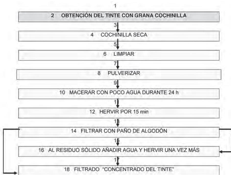
Figura 1. Extracción del tinte a partir de grana cochinilla (Tomado de Portillo y Viguera 1995)
