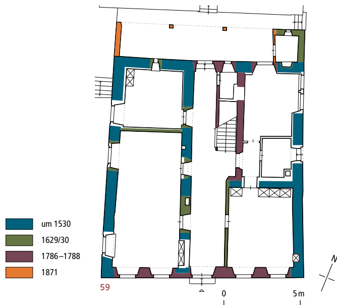
ABB. 59 Oberbipp. Herren-gasse 1. Pfarrhaus. Grundriss Erdgeschoss 1:250. Der Bauphasenplan lässt die einstige Orientierung nach Westen gut erkennen: Der annähernd quadratische Stock hatte zum Westen hin seine grossen Öffnungen. Die zweite Bauphase veränderte die innere Raumaufteilung, während der grosse Umbau von 1786–1788 diese weitgehend übernahm und das Haus durch die vollständig erneuerte Südseite umorientierte. Im 19. Jh. errichtete man unter der wohl schon bestehenden Obergeschosslaube ein Peristyl für den angenehmen Aufenthalt im Garten. Zeichnung Urs Bertschinger und Rolf Bachmann, 2017. KDP.
