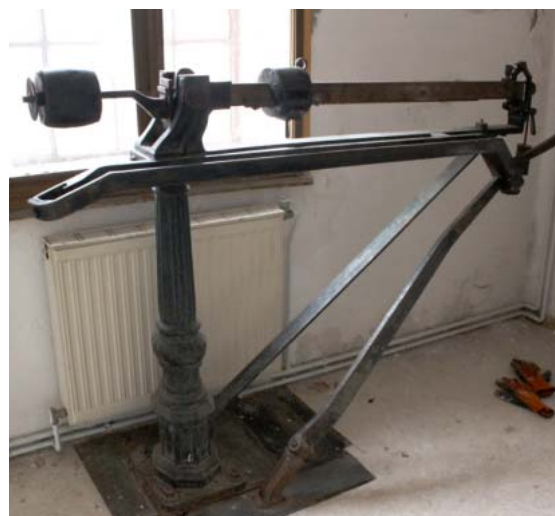
Abb. 55: Im Inneren des Speichergebäudes von Abb. 57. Dicke Mauern und Fenster ermöglichen optimale Temperatur und Trockenheit zum Lagern landwirtschaftlicher Güter. Abb 56 (re.): Der im Gebäude (in Abb. 58, rechts) befindliche Hebelarm der Brückenwaage scheint noch funktionsfähig zu sein und reagiert darauf, wenn außen die Stellfläche belastet wird. Bis 2015 war der Bauernhof noch in Betrieb, dann kaufte ihn der Wohnfonds Wien, um das Areal mittelfristig mit Großwohnsiedlungen zu bebauen.
