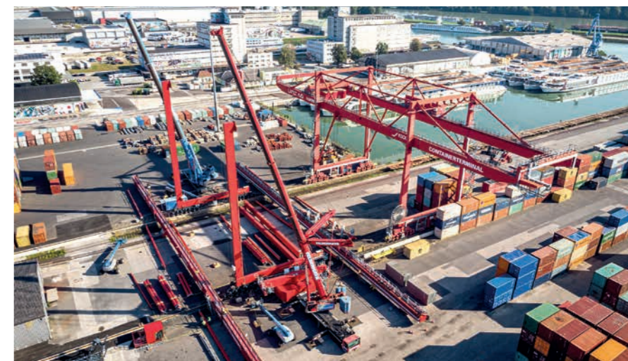
Die Krananlage kann mit einem Eigengewicht von 522 Tonnen, einer Breite von 31,11 Metern und einer Gesamthöhe von 36,35 Metern eine Gesamtnutzlast von 41 Tonnen stemmen.
