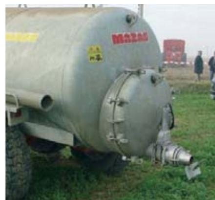
Foto 16. Cisterna de purín acoplada en un camión de tres ejes. Foto 17 (dcha.). Boquilla con deflector.
