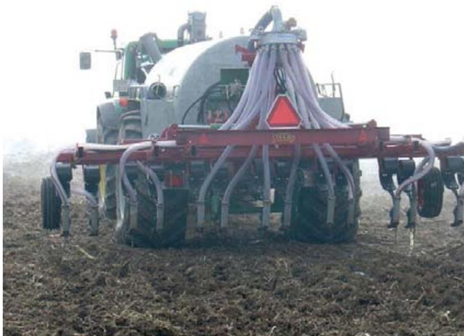
Foto 19. Cisterna con sistema de enterrado mediante rejas escarificadoras montadas sobre brazos flexibles (observar el triturador-repartidor horizontal).
