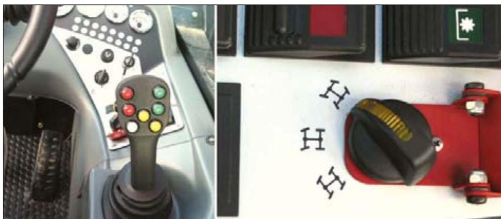
Palanca multifunción y selector del tipo de dirección.
