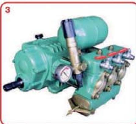
**3** • Con nuestra bomba de eje pasante y reductora única en el mercado, se reduce el consumo de potencia del tractor, con el consiguiente ahorro económico obtenemos también un aumento de la vida útil de todos los componentes de fricción de la bomba, debido a la diferencia de revoluciones a las que trabaja con respecto a una bomba directa.
