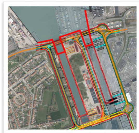
Figuur 5.14: contouren stormvloedkering (links: t.h.v. Visartsluis – rechts t.h.v. Vandammesluis en nieuwe zeesluis) (Tractebel, 2016 d)
