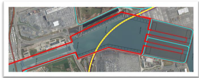
Figuur 5.19: contouren stormvloedkering t.h.v. Visartsluis (links) en Verbindingsdok (rechts-variant Nx tunnel) (Tractebel, 2016 h)
