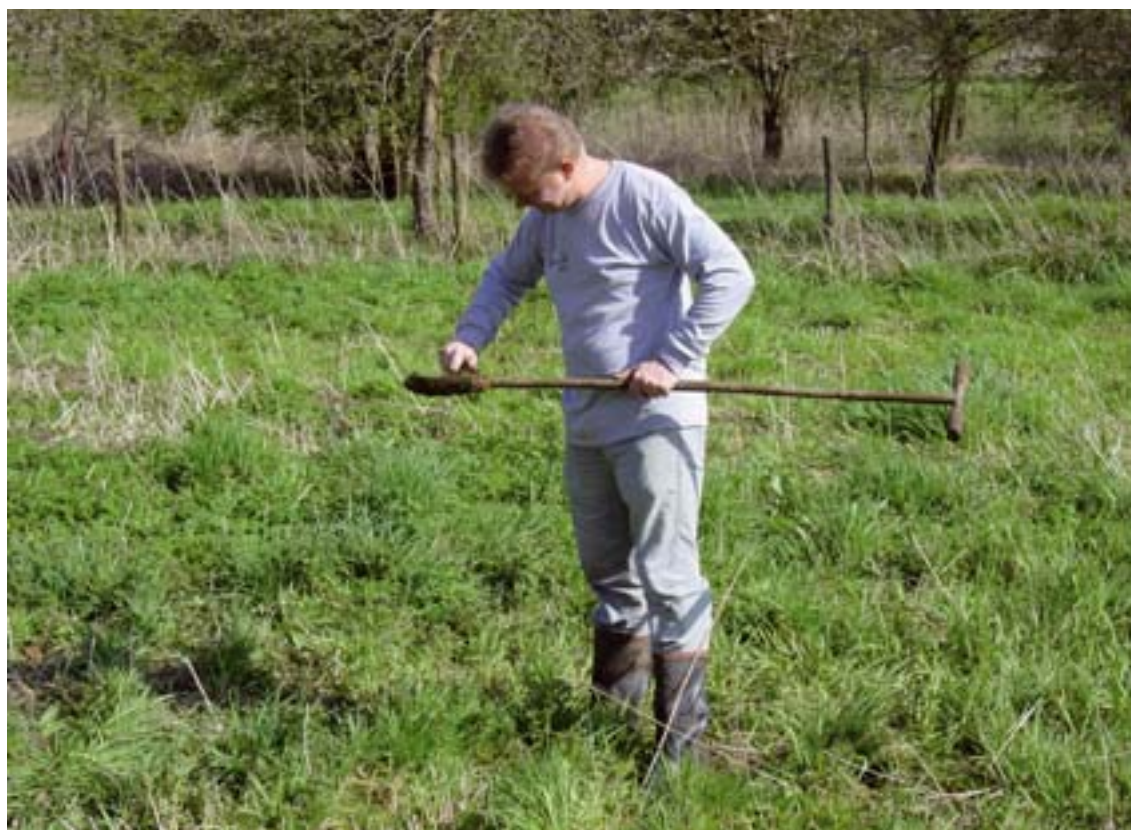
Figuur 21. Impressie van het booronderzoek met de Edelmanboor.
