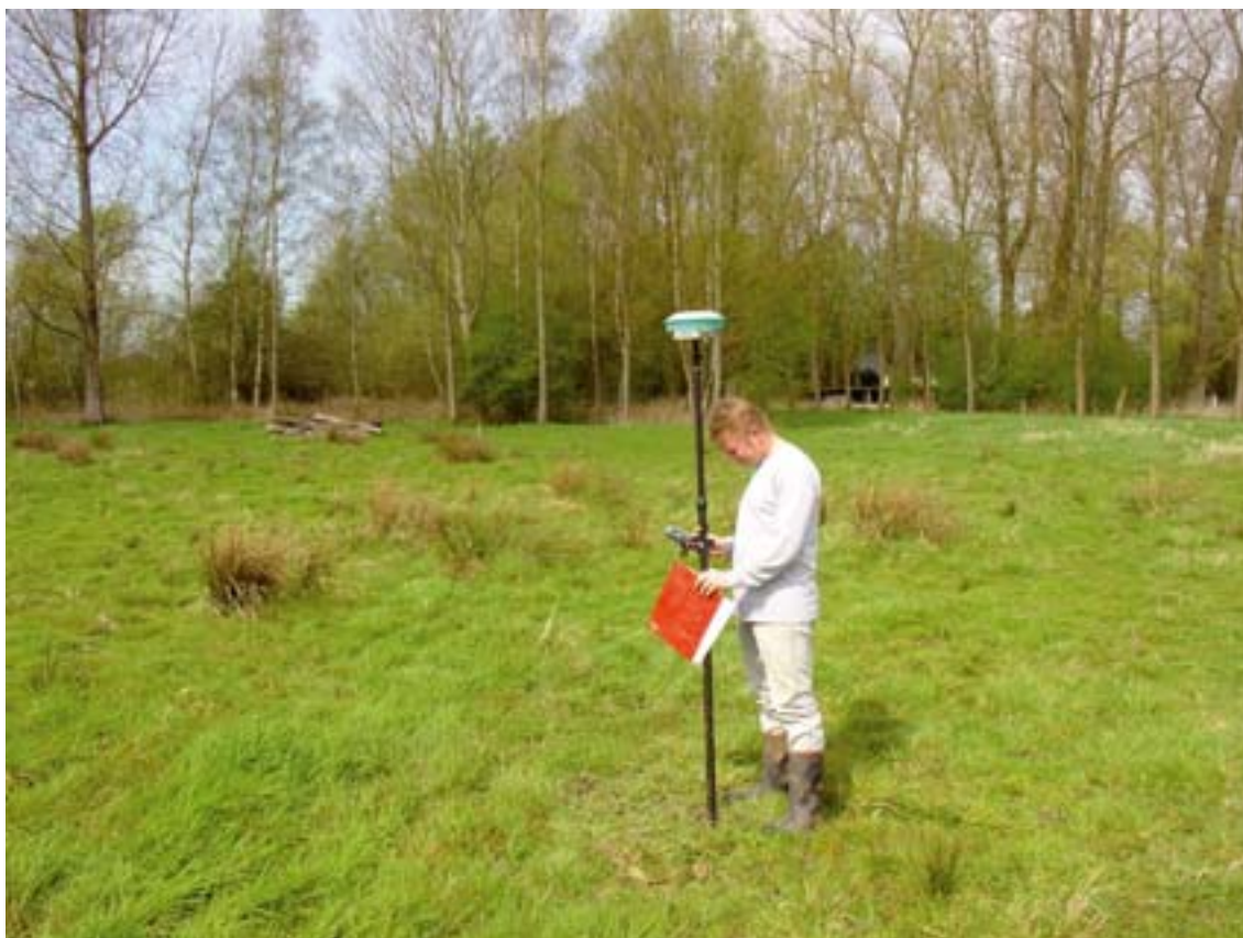
Figuur 23. Impressie van het inmeten van de boorpunten met behulp van GPS.
