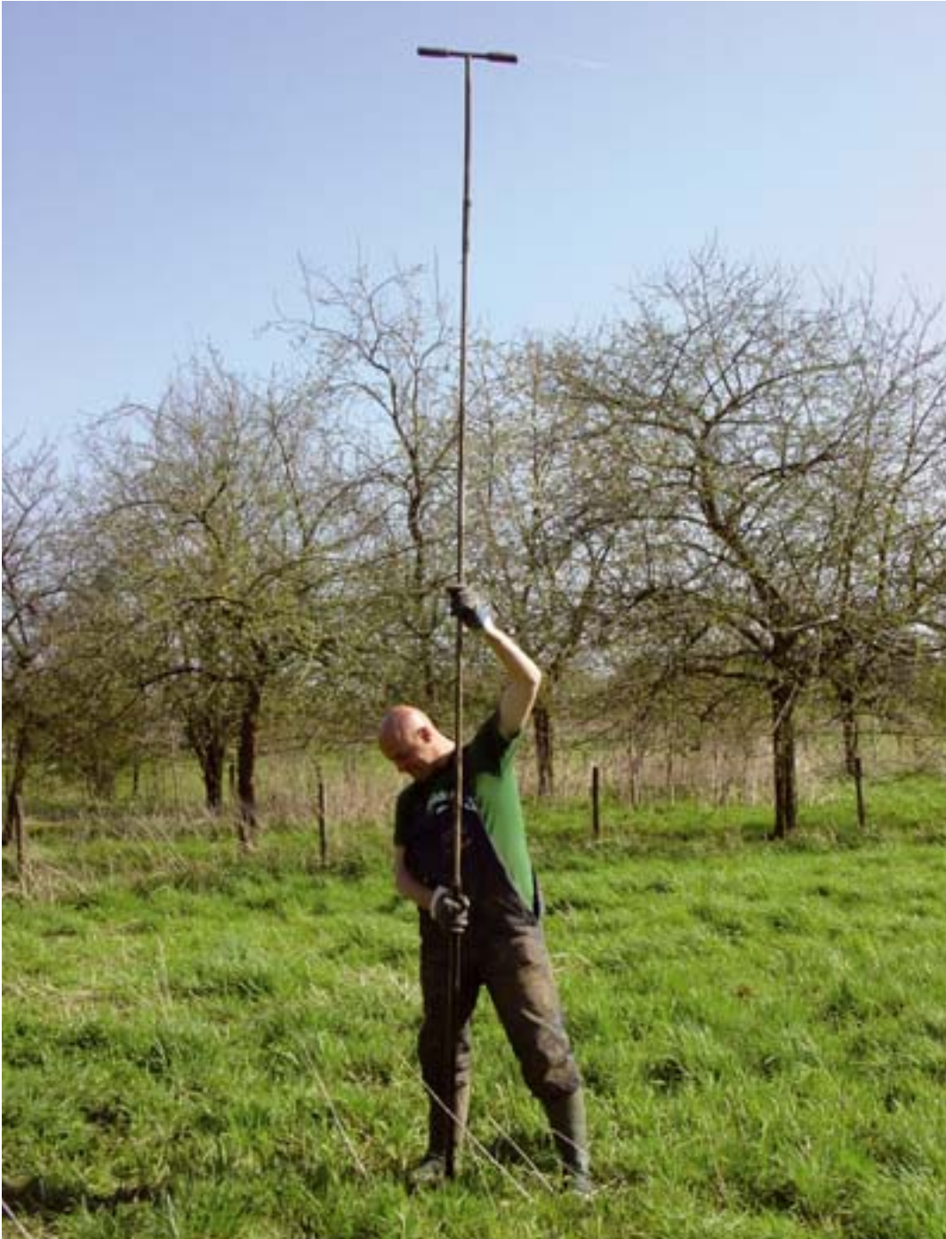
Figuur 22. Impressie van het booronderzoek met de gutsboor.
