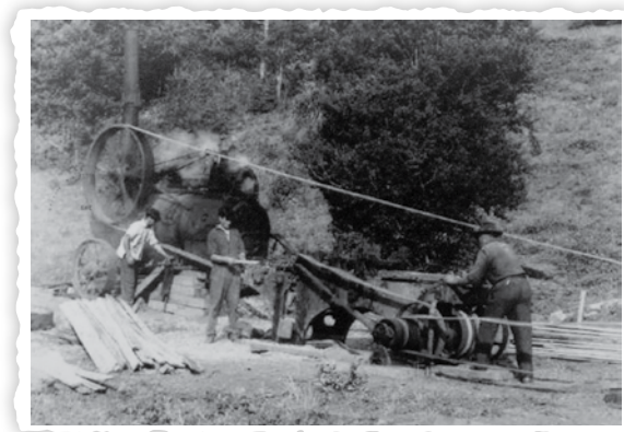
Banco de aserradero impulsado por locomóvil.
