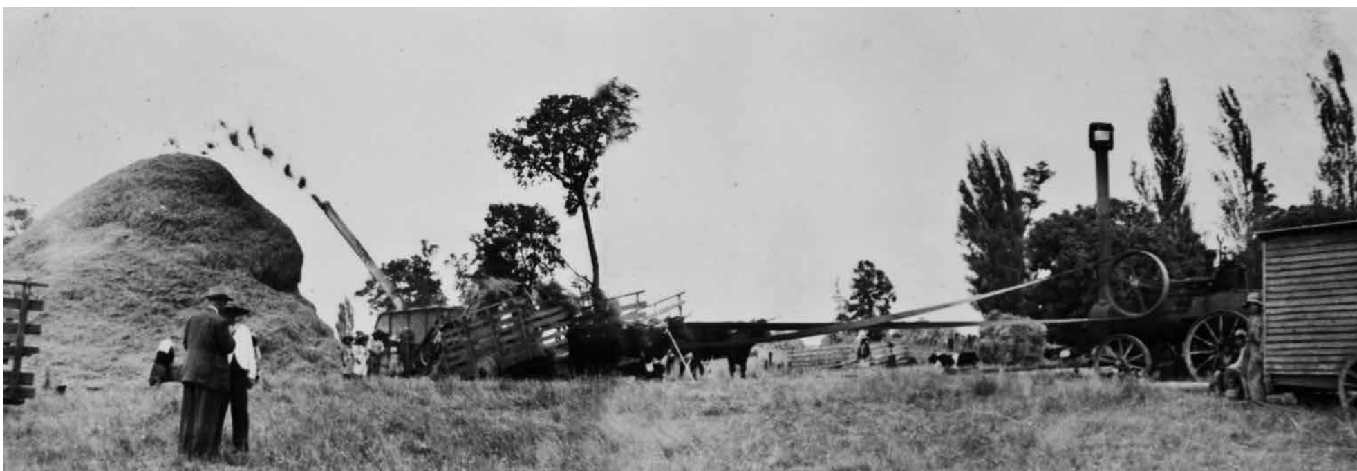
Trilla con máquina estacionaria.
