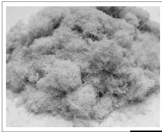
Figura 6-10. Fibra típica para fabricación de tableros MDF. Tomada y modificada de [6]
