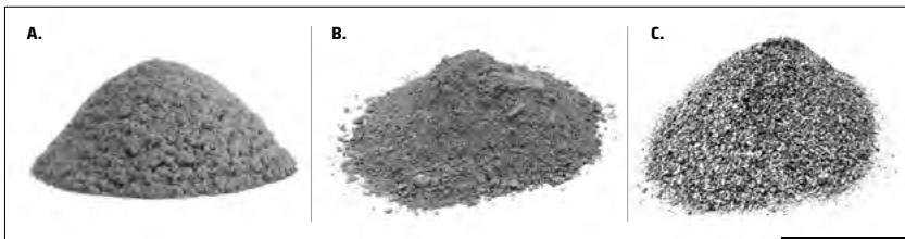
Figura 6-28. Materia prima para compuestos madera-cemento. A. Fibras de madera. B. Cemento Portland. C. Partículas de madera. Tomada y modificada de [147]
