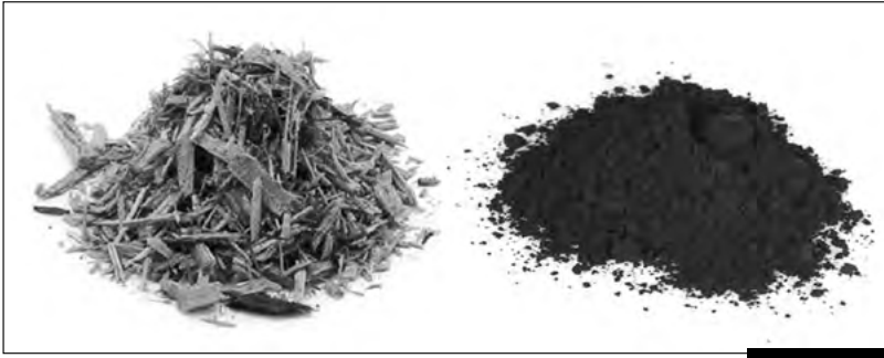
Figura 6-55. Conversión de subproducto maderero a carbón activado. Tomada y modificada de [137]
