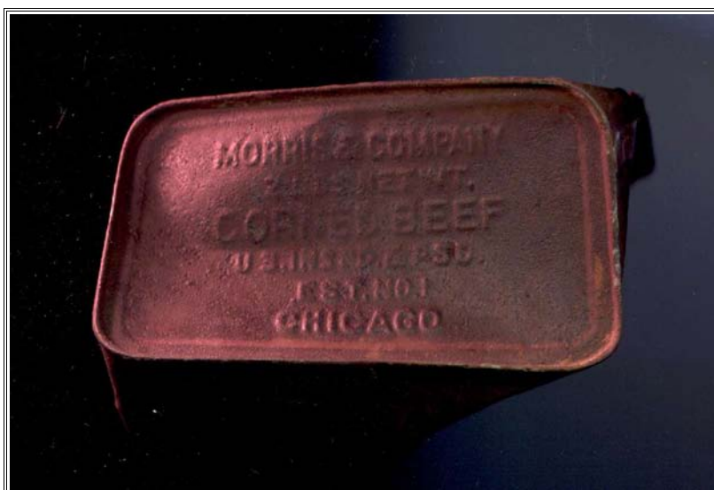
Foto 40 y 41. Vista longitudinal y transversal de una de las latas de El Periquete perteneciente a la Morrison & Company de Chicago. La lata es de doble costura sin soldaduras.
