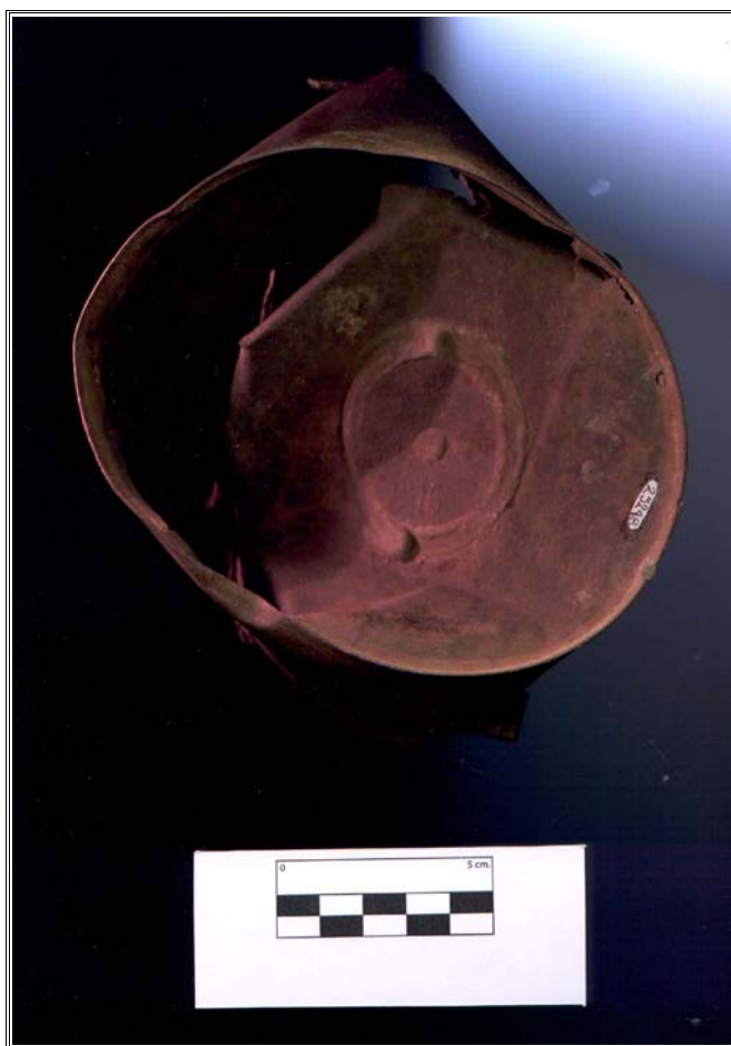
Foto 50. Lata con orificio central y casquillo donde son evidentes las soldaduras. En el casquillo tiene impresos los números 8 – 16 (¿Ago 1916?).
