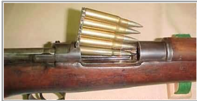
Foto 68 y 69. (Izq) Slipper clip con las cinco balas de calibre .30.06 del M1903 Springfield. (Der) Uso del Slipper clip en el rifle.
