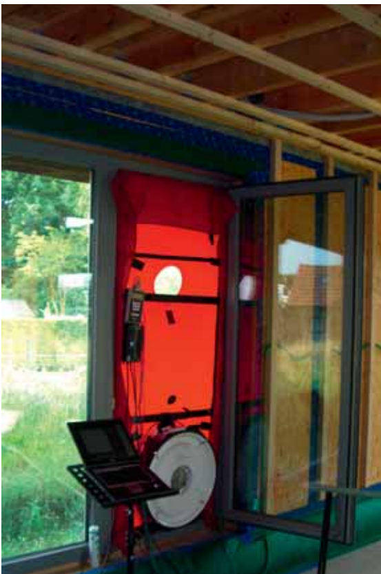
De BlowerDoor-luchtdichtheidstest visualiseert duidelijk de impact van luchtlekken. (© Isoproc-Innoviso)
