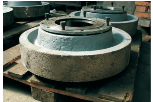
▶ Laufrolle - alter Zustand mit beschädigter Lauffläche
