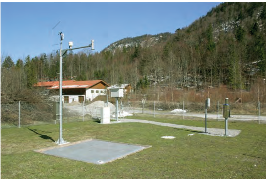
▲ Messfeld mit Temperatur-, Regen- und Schneehöhenmesser zur Ermittlung von aktuellen Wetterdaten
