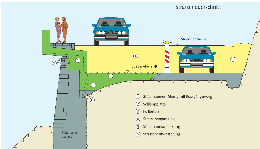
◀ Stützmauerquerschnitt mit alter und neuer Straßenebene
