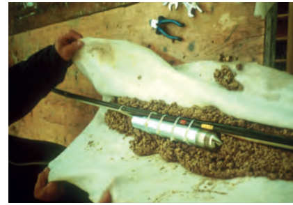
▲ Einbau neuer Porenwasserdruck-Sonden in Bohrlöcher
