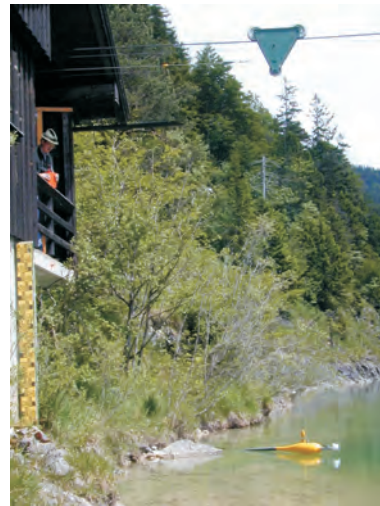
▲ Abflussmessung am Sylvensteinpegel mit Messflügel und Seilkrananlage
