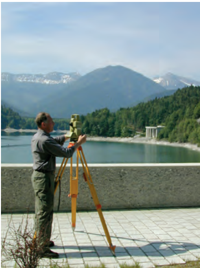
◀ Mitarbeiter des Wasserwirtschaftsamts beim Feinnivellement der Höhenfestpunkte
