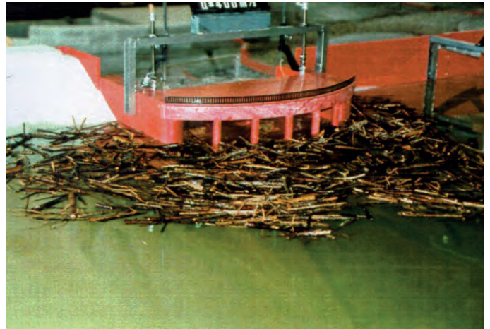
▲ Modellversuch - Einlaufbauwerk mit Treibzeugfang (Versuchsanstalt Obernach der TU München)
