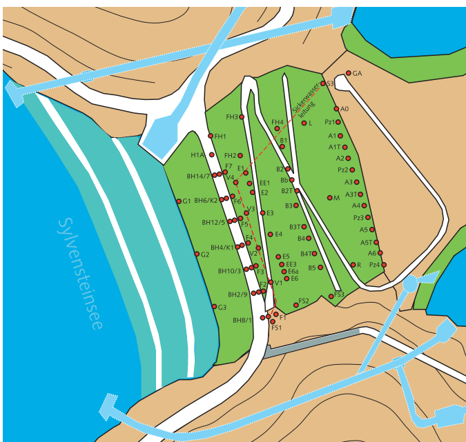
▲ Umfangreiches Messsystem im Grundriss
