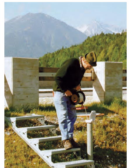
▶ Der Wasserstand in einem Beobachtungspegel im Dam wird mit einem Lichtlot gemessen
