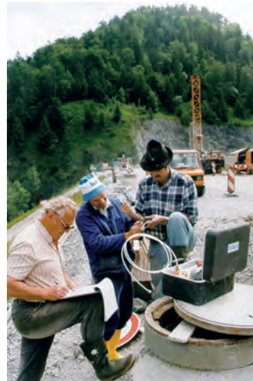
◀ Nullmessung für die Kalibrierung der Porenwasserdruckgeber
