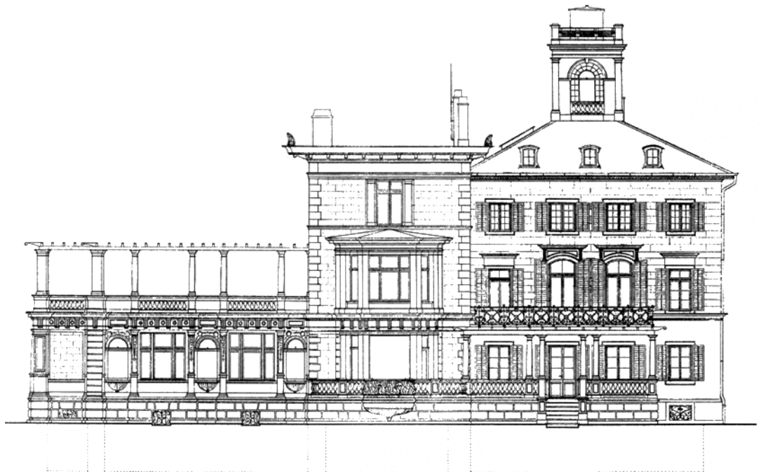
Villa (Grosser) «Freudenberg». Zürichbergstrasse 6/Rämistrasse 62. Abgebrochen 1966. Veränderungen der Südwestansicht. Aufnahmeplan des Kantonalen Hochbauamtes (Gossweiler), datiert 7. Juli 1947. Bauzustand 1906–1966, mit der Erweiterung von Friedrich Wehrli 1906 (zweites Obergeschoss und Turm am ursprünglichen Bau von 1855).
