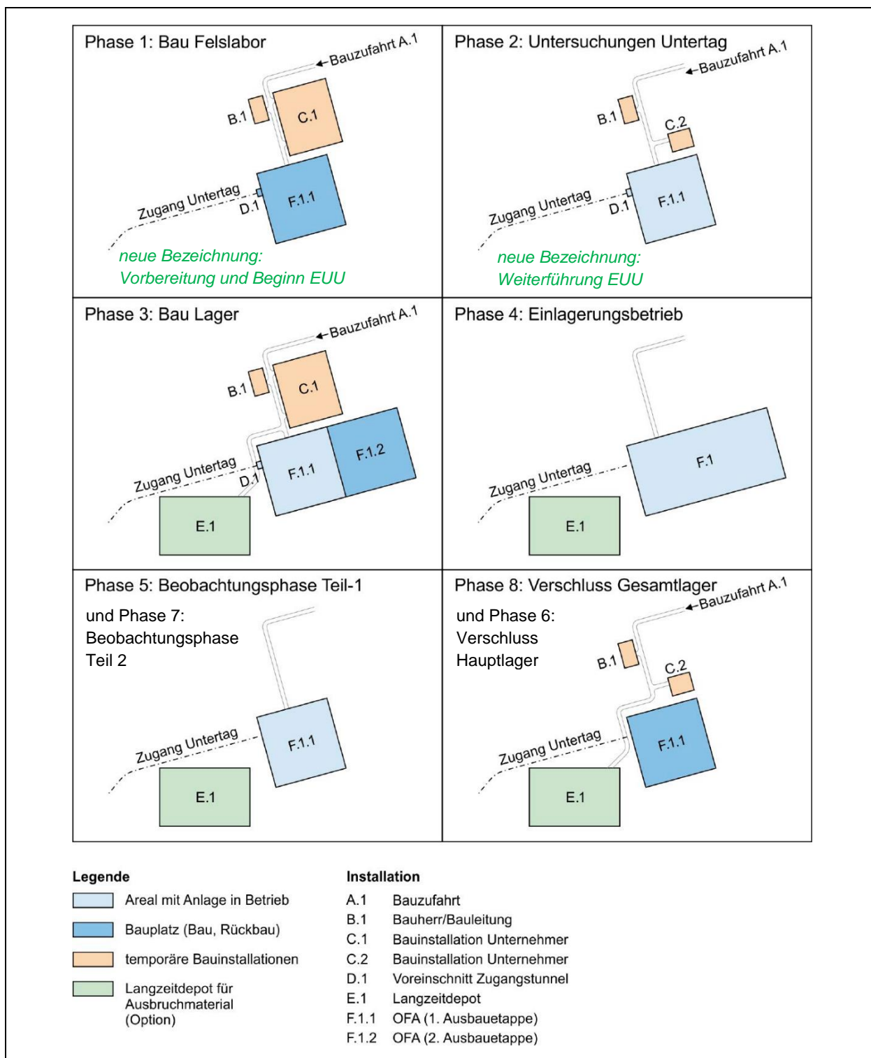
Abb. 31 Schema der benötigten Flächen beim OFA-Areal nach Realisierungsphase für ein SMA- bzw. ein HAA-Lager. (aus Nagra Planungsstudien, z. B. NTB 13-66 und 13-67, ergänzt durch BFE).
